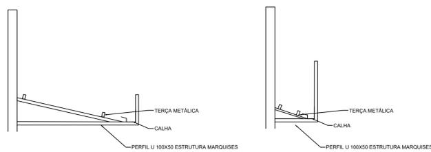
Detalhamento Platibanda de Zinco Sem Escala
