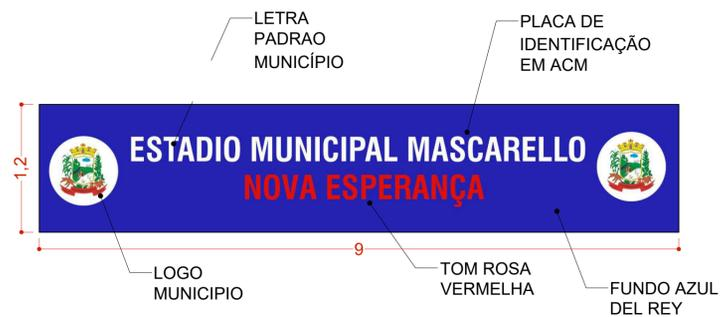
Detalhamento 01 Placa identificação Sem Escala
