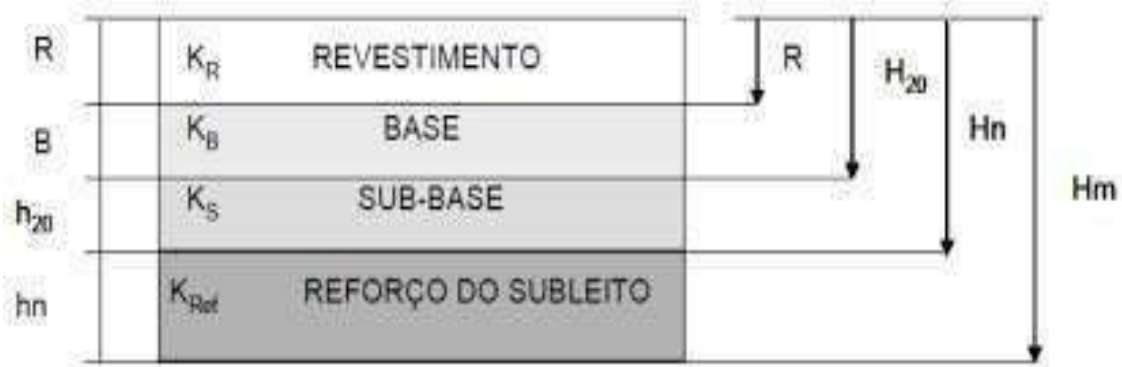
Figura 03. Dimensionamento de pavimento flexível
