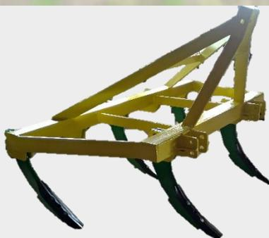
Subsolador acoplável ao braço hidráulico do trator peso de 300 a 500 kg
