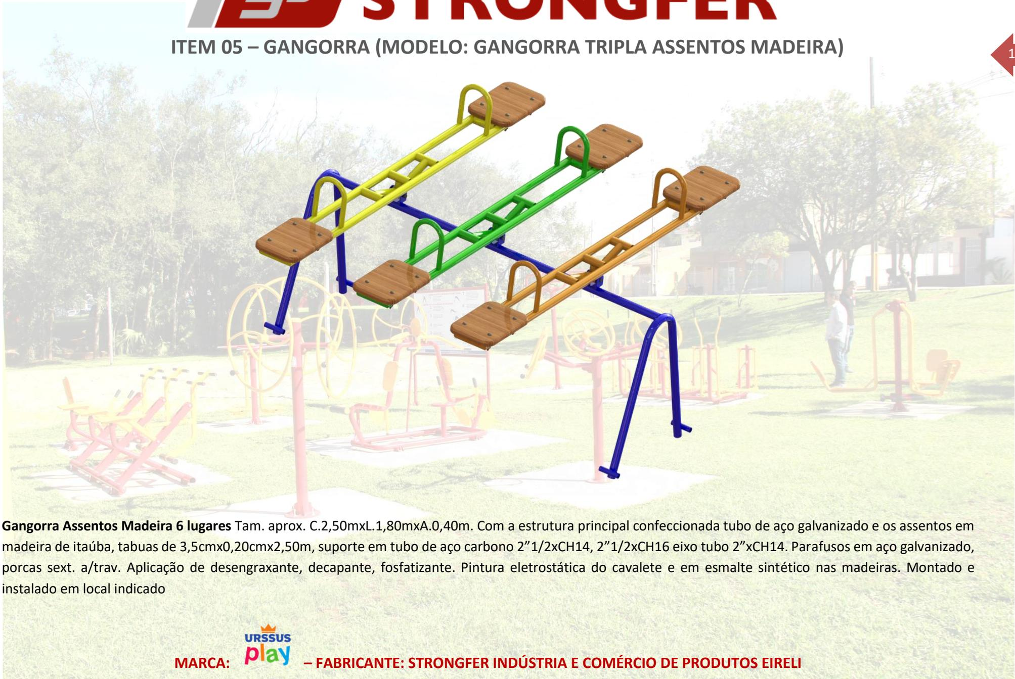
**Gangorra Assentos Madeira 6 lugares** Tam. aprox. C.2,50mxL.1,80mxA.0,40m. Com a estrutura principal confeccionada tubo de aço galvanizado e os assentos em madeira de itaúba, tabuas de 3,5cmx0,20cmx2,50m, suporte em tubo de aço carbono 2"1/2xCH14, 2"1/2xCH16 eixo tubo 2"xCH14. Parafusos em aço galvanizado, porcas sext. a/trav. Aplicação de desengraxante, decapante, fosfatizante. Pintura eletrostática do cavalete e em esmalte sintético nas madeiras. Montado e instalado em local indicado
