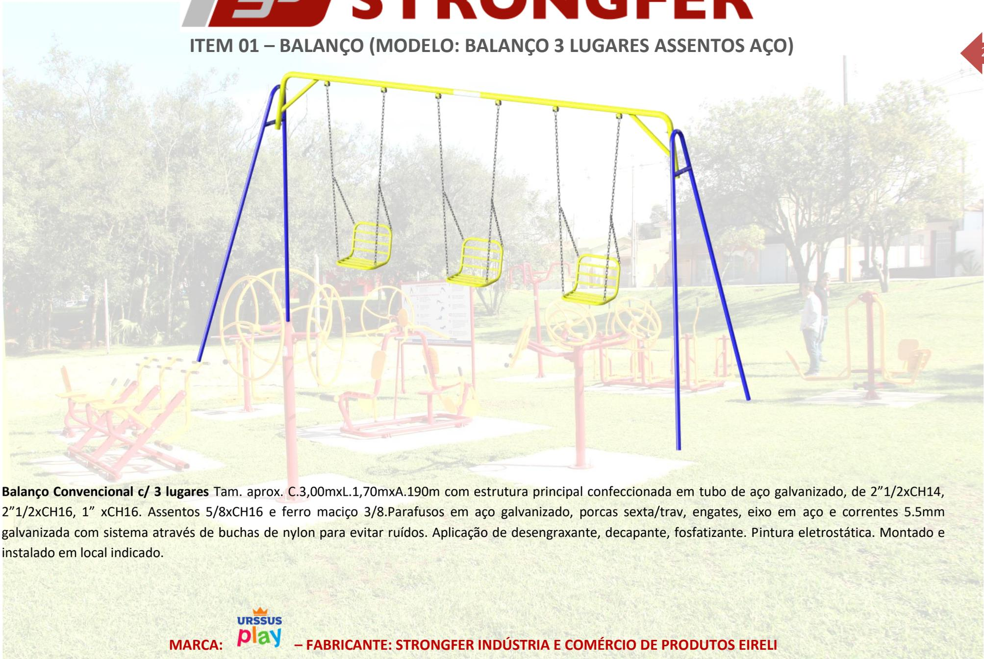
**Balanço Convencional c/ 3 lugares** Tam. aprox. C.3,00mxL.1,70mxA.190m com estrutura principal confeccionada em tubo de aço galvanizado, de 2”1/2xCH14, 2”1/2xCH16, 1” xCH16. Assentos 5/8xCH16 e ferro maciço 3/8.Parafusos em aço galvanizado, porcas sexta/trav, engates, eixo em aço e correntes 5.5mm galvanizada com sistema através de buchas de nylon para evitar ruídos. Aplicação de desengraxante, decapante, fosfatizante. Pintura eletrostática. Montado e instalado em local indicado.
