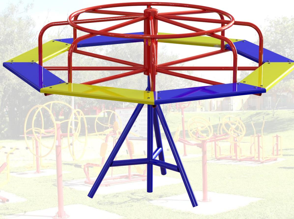
**Carrossel oitavado assento em Madeira itauba** com a estrutura principal confeccionada em tubo galvanizado de 1"1/4xCH14, 1" xCH16. Tam. aprox. Diam.1,80m x Circ.5,65mxA.0,80m. eixo tubo carbono Skeduli 2"1/2xCH9, 1"1/2xCH9, c/ rolamento 30.210. Aplicação de desengraxante, decapante, fosfatizante. Pintura eletrostática. Montado e instalado em local indicado. (conforme imagem ilustrativa em anexo ao edital)
