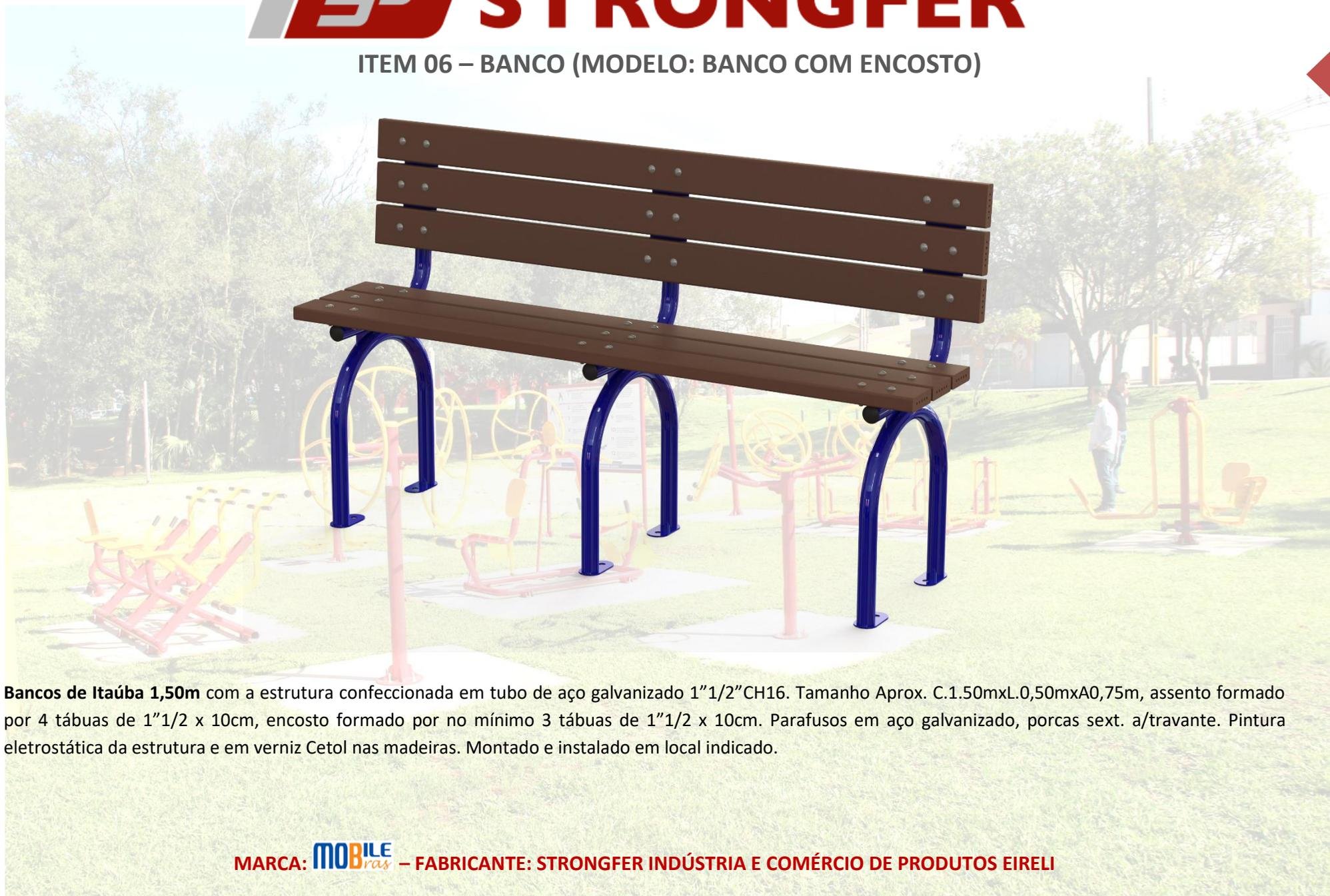
**Bancos de Itaúba 1,50m** com a estrutura confeccionada em tubo de aço galvanizado 1”1/2”CH16. Tamanho Aprox. C.1.50mxL.0,50mxA0,75m, assento formado por 4 tábuas de 1”1/2 x 10cm, encosto formado por no mínimo 3 tábuas de 1”1/2 x 10cm. Parafusos em aço galvanizado, porcas sext. a/travante. Pintura eletrostática da estrutura e em verniz Cetol nas madeiras. Montado e instalado em local indicado.
