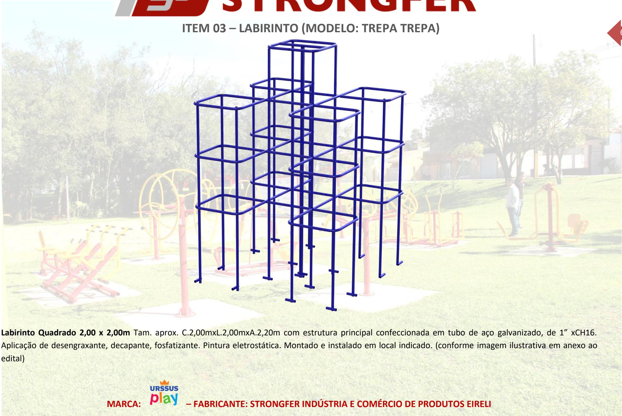
**Labirinto Quadrado 2,00 x 2,00m** Tam. aprox. C.2,00mxL.2,00mxA.2,20m com estrutura principal confeccionada em tubo de aço galvanizado, de 1" xCH16. Aplicação de desengraxante, decapante, fosfatizante. Pintura eletrostática. Montado e instalado em local indicado. (conforme imagem ilustrativa em anexo ao edital)
