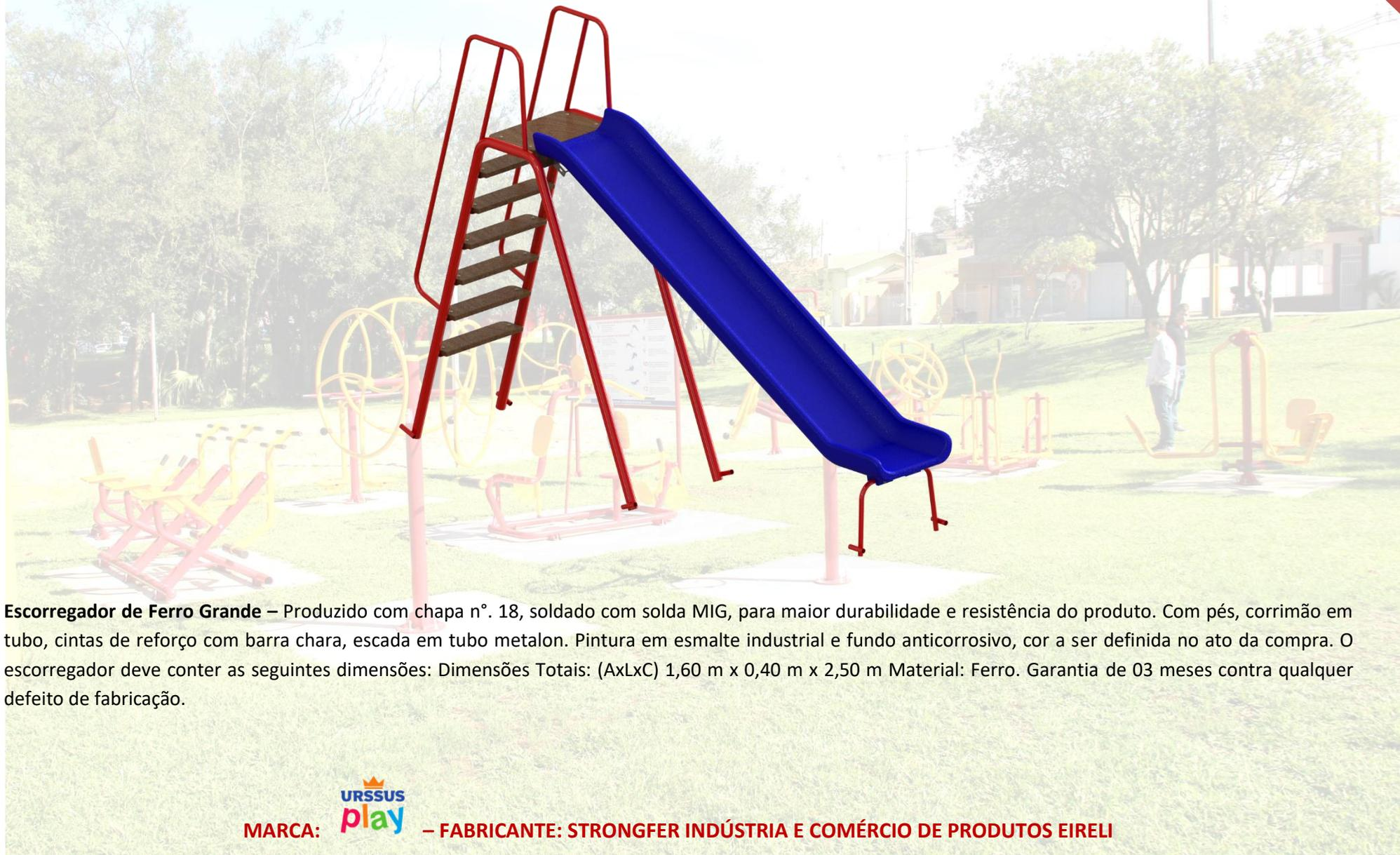
**Escorregador de Ferro Grande** – Produzido com chapa n°. 18, soldado com solda MIG, para maior durabilidade e resistência do produto. Com pés, corrimão em tubo, cintas de reforço com barra chara, escada em tubo metalon. Pintura em esmalte industrial e fundo anticorrosivo, cor a ser definida no ato da compra. O escorregador deve conter as seguintes dimensões: Dimensões Totais: (AxLxC) 1,60 m x 0,40 m x 2,50 m Material: Ferro. Garantia de 03 meses contra qualquer defeito de fabricação.
