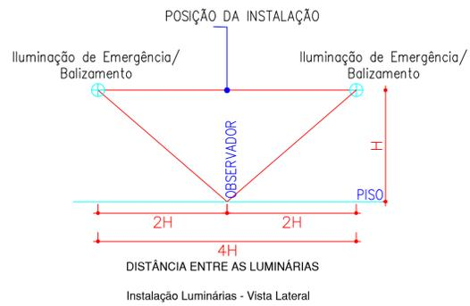
A instalação das luminárias deverá ser na altura máxima igual a contra verga da abertura mais elevada (porta ou janela). Essa distância do piso até a luminária será H. A distância horizontal entre as luminárias será igual a 4H. As alturas adotadas em projeto são: H=2,50m e 4H=10,00m. A posição das luminárias deverão indicar a rota de saída mais próxima da edificação.
