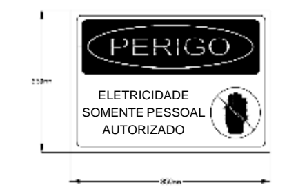
DETALHE DA PLACA DE ADVERTÊNCIA
