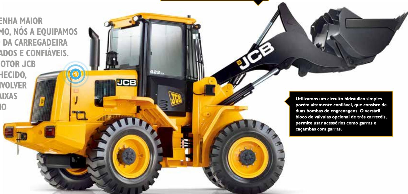
Utilizamos um circuito hidráulico simples porém altamente confiável, que consiste de duas bombas de engrenagens. O versátil bloco de válvulas opcional de três carretéis, permite usar acessórios como garras e caçambas com garras.
