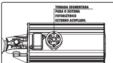
TOMADA SEGMENTADA PARA O SISTEMA FOTOELÉTRICO EXTERNO ACOPLADO.
